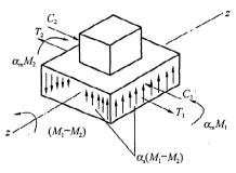
图 3 板与柱不平衡弯矩传递示意
