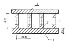
图 9 模型试验®轴剖面图 1一框架梁, 2一柱, 3一传感器, 4一筏板
