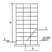
(a) 地下室为箱基、上部结构为框架或框架-剪力墙结构时的嵌固部位
