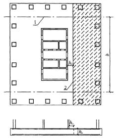
图 7 框架-核心筒下筏板受剪承载力计算截面位置和计算单元宽度 1-混凝土核心筒与柱之间的分界线,2-剪切计算截面,6-验算单元的计算宽度
