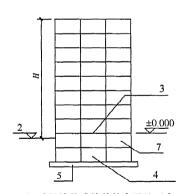
(b)采用筏基或箱基的多层地下室, K<sub>B</sub>≥1.5K<sub>i</sub>,上部结构为框架或 框架-剪力增结构时的嵌固部位
