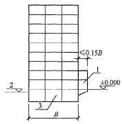
图 6.3.17 箱形基础挑出部位示意 1一裙房; 2一室外地坪; 3一箱基
