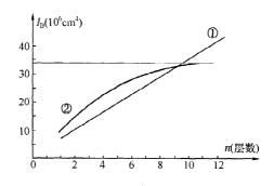
图 15 等效刚度计算结果 ①一按《高层建筑箱形基础设计与施工规程》JGJ 6-80 的等效
