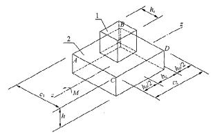
图 6.2.2 内柱冲切临界截面示意 1-柱: 2-筏板
