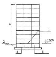
(c)采用筏基的单层地下室,K<sub>B</sub>≥1.5K<sub>F</sub>, 上部结构为框架或框架-剪力墙结 构时的嵌固部位
