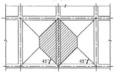
图 6.3.10 计算墙竖向剪力时地基反力分配图
