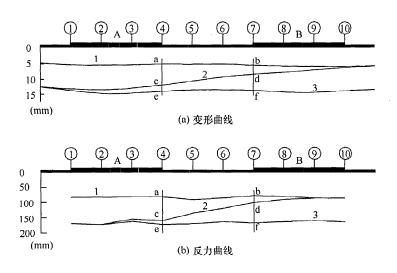
图 1 双塔楼不同加载路径反力、变形曲线 1-主楼 A、B同步加载至 800kN; 2-主楼 A由 800kN 加载至 1600kN, 主楼 B持载 800kN; 3-主楼 B由 800kN 加载至 1600kN, 主楼 A 持载 1600kN
