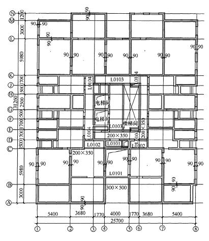
图 2 一梯十户剪力墙结构住宅平面
