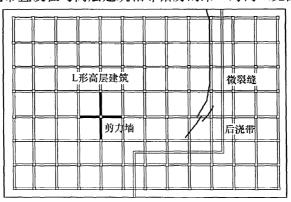
图 13 后浇带(沉降缝)示意图
