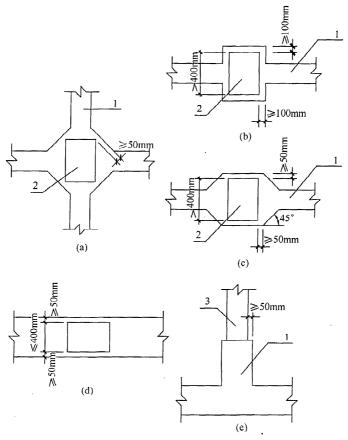
图 6.2.8 地下室底层柱和剪力墙与梁板式筏基的基础梁连接构造 1—基础梁: 2—柱; 3—墙
