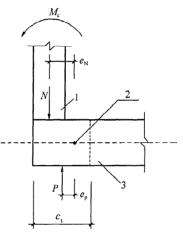
边柱 Munb 计算示意图 对于内柱,由于对称关 1—冲切临界截面重心,2—柱,3—筏板
