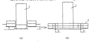
图 6.2.14 后浇带 (沉降缝) 示意
