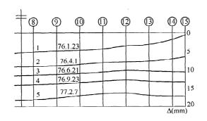
图 14 北京中医医院病房楼箱形基础纵向沉降曲线图 1—四层,2—八层,3—主体完工,4—装修阶段Ⅰ,5—装修阶段Ⅱ
