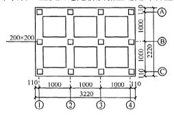
图 8 模型试验平面图
