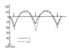
图 11 整体分析法与倒梁板法弯矩计算结果比较 1-整体(考虑上部结构刚度); 2-倒梁板法
