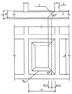
图 6.3.4 底板的冲切计算示意 1—冲切破坏锥体的斜截面; 2—墙; 3—底板
